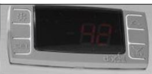
CONTROL DE TEMPERATURA
